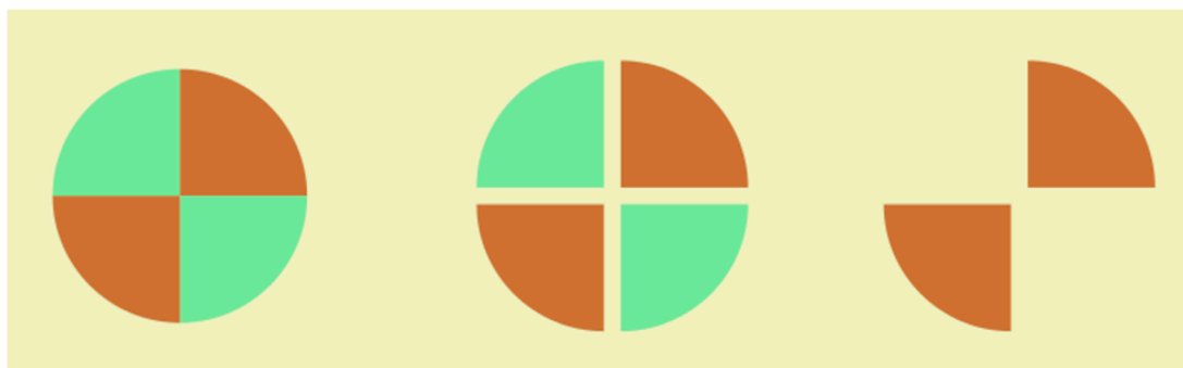
Slika 1.: Grafični prikaz metode mešanja in deljenja vzorca s četrтинjenjem oz. metode delitve vzorca na četrтine
