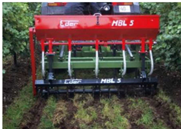
Slika 5: Grobo rahljanje tal oskrbovanih z negovano ledino in dodajanje gnojil z »odlagalcem« za izboljšanje založenosti tal s hranili v drugem horizontu tal (Foto: S. Vršič)
