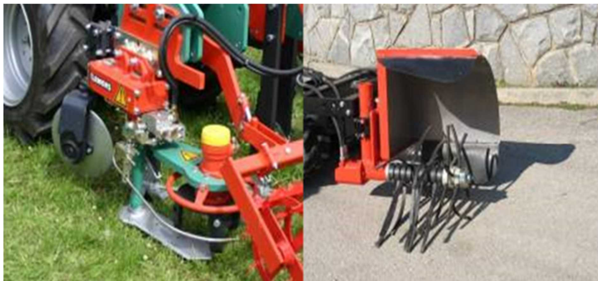
Slika 6: Podrezovalnik plevelov (slika levo) in prirejen pletvenik (slika desno) za mehansko zatiranje plevelov v vrsti (Foto S. Vršič)
