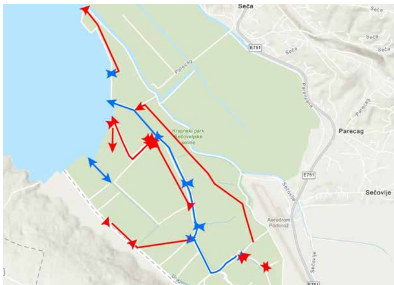
Sl. 7. SHEMATIČNI PRIKAZ NALIVANJA OZ. PREMIKANJA VOD NA OBMOČJU FONTANIGGE. Z MODRO JE OZNAČENO NALIVANJE MORSKE VODE IZ NALIVNIH KANALOV PREK ZAPORNIČNIH SISTEMOV (KALIJEV) V BAZENE, Z RDEČO PA PREMIK VOD MED POSAMEZNI MI BAZENI, Z NAMENOM ZAGOTAVLJANJA USTREZNEGA NIVOJA VODE, KI GA ODČITAVAMO S POMOČJO MERSKIH LAT.
