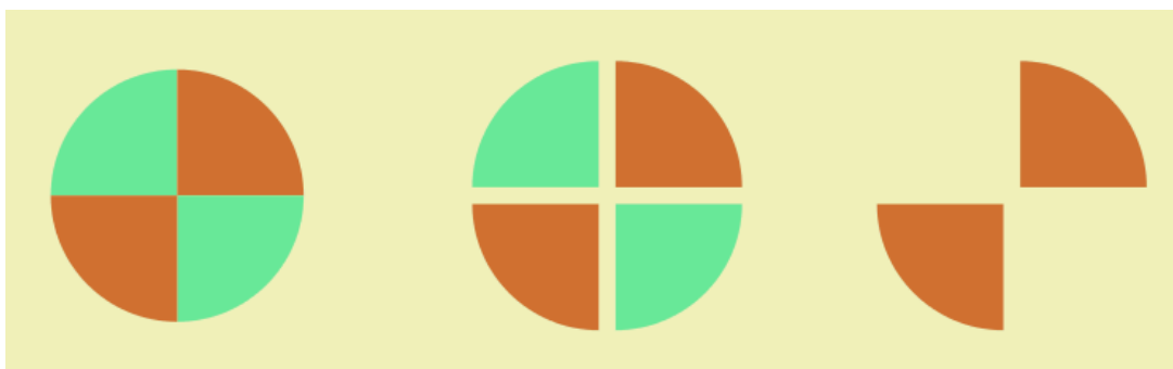
Slika 1: Grafični prikaz metode mešanja in deljenja vzorca s četrtinjenjem
