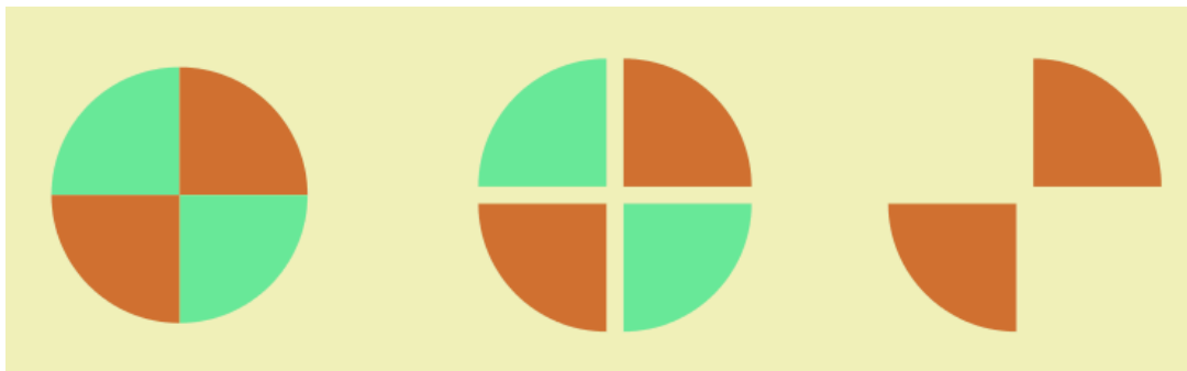
Slika 1.: Grafični prikaz metode mešanja in deljenja vzorca s četrtinjenjem oz. metode delitve vzorca na četrtine
